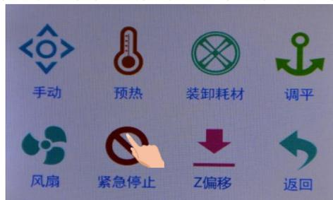
3.7点击Z偏移图标，进入Z轴位置调整。目测喷嘴与平台的距离，先将移动单位设置为1mm，点击
