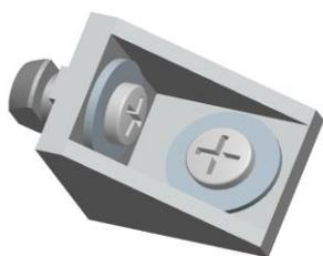
2.取L角码1个,2个机米螺丝M5\*5,按图示方向,拧入2个机米螺丝,不要伸出背面。组装好12组件备用。
