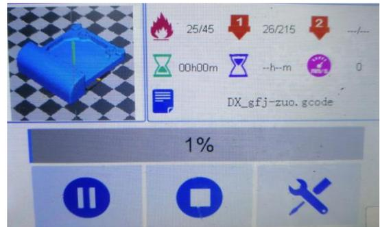
4.2.1 点击
