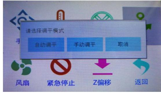
3.4.2 点击自动调平，机器运转，读取设置点的参数后，保存。读数偏离0.8以上，调整该点平台下的螺母后，重新调平。
