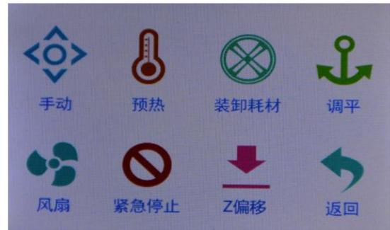
3.1. 点击手动菜单，进入手动调整模式。对电机转动调整，E挤出机进/退料，XYZ轴电机移动，图标0.01mm，0.1mm，1mm，10mm，点击后深色显示，如图标10mm，表示每点击一次电机行程移动10mm。点击 图标，机器返回原点。点击 返回上级菜单。
