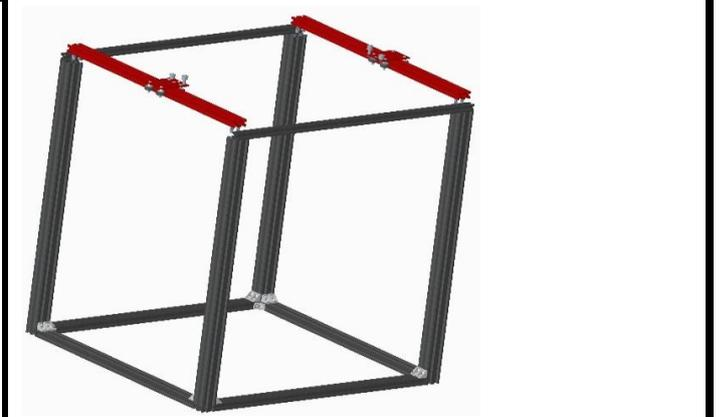
3.将铝型材5组件按图示位置组装，将L角码对齐铝型材槽位卡入，用PM6\*25的螺丝分别拧入图示孔位。（不要锁紧，方便后续调整）
