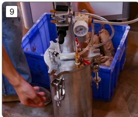
Align the position of the buckle 对齐卡扣的位置
